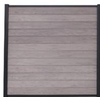
Die Breite der in den Standardmaßen 180x180cm (BxH) erhältlichen Selbstbau-Sets kann durch Einkürzen der einzelnen Komponenten eventuell selbst angepasst werden. Um eine eventuelle Längenausdehnung durch witterungsbedingte Schwankungen zu gewährleisten, müssen die Steckelemente allerdings um 0,7cm kürzer gehalten werden als das Maß zwischen den Pfosten, welches von den Innenseiten innerhalb der Pfostennuten gemessen wird.
